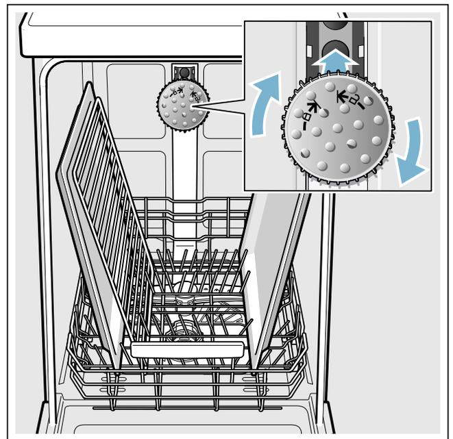
Damit der Sprühstrahl alle Teile erreichen kann, ordnen Sie die Bleche wie abgebildet ein (maximal 2 Backbleche und 2 Gitter).
