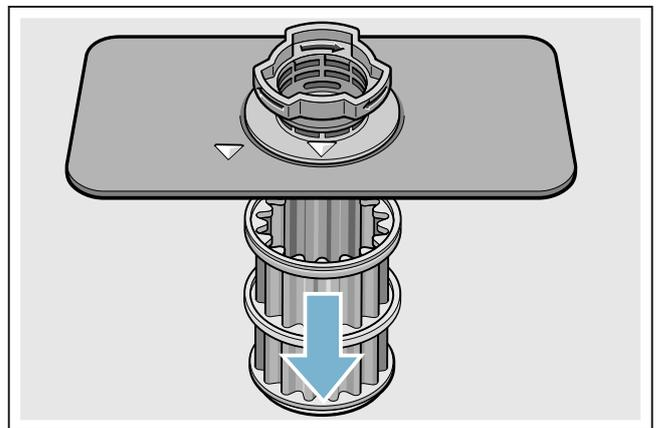
3. Eventuelle Reste entfernen und Siebe unter fließendem Wasser reinigen.
