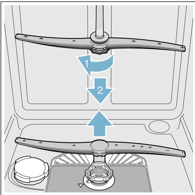
4. Sprüharme unter fließendem Wasser reinigen.
